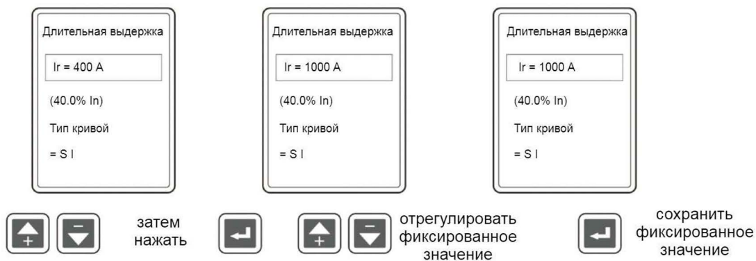
Рис. 8 Пример операций в меню: настройка защиты от перегрузки с длительной выдержкой по времени
