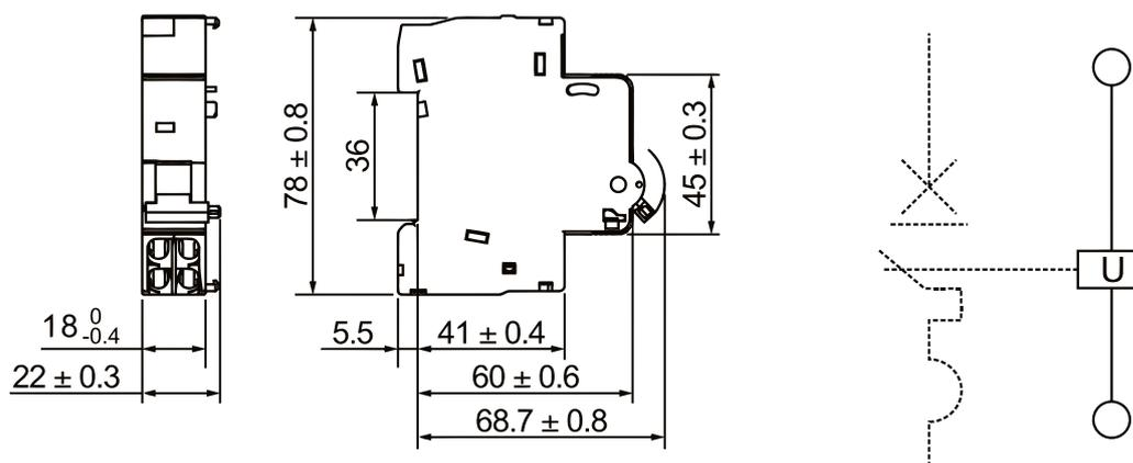
Аксессуары устанавливаются с левой стороны автоматического выключателя. Общая ширина установленных аксессуаров не должна превышать 54 мм. Максимальное количество устанавливаемых аксессуаров MX, MN, MV, MNS, MV+MN, MX+OF: не более двух одновременно.
