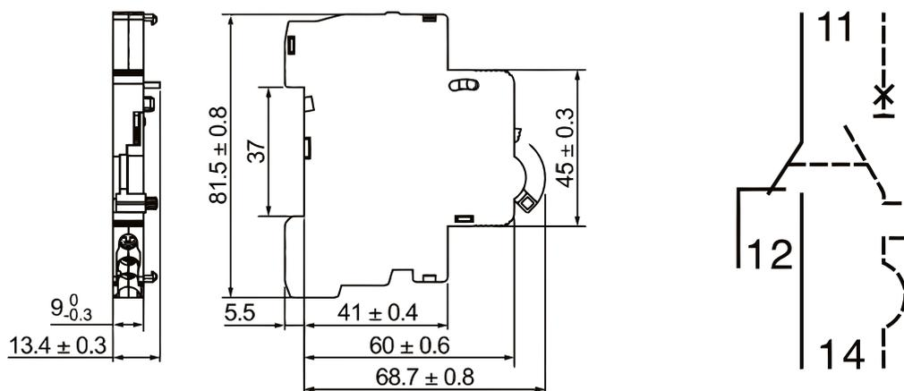
Аксессуары устанавливаются с левой стороны автоматического выключателя. Общая ширина установленных аксессуаров не должна превышать 54 мм. Максимальное количество устанавливаемых аксессуаров MX, MN, MV, MNS, MV+MN, MX+OF: не более двух одновременно.
