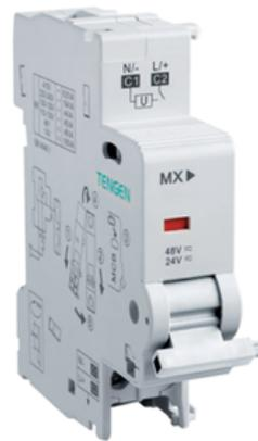
Независимый расцепитель TGB1N-MX применяется для дистанционного отключения автоматического выключателя или автоматического выключателя дифференциального тока. Устанавливается с левой стороны автоматических выключателей серий TGB1N-63, TGBG-63DC, TGBMA-63, а также автоматических выключателей дифференциального тока TGB1NLE-32(63), TGB1NLE(LA)-63Y.
