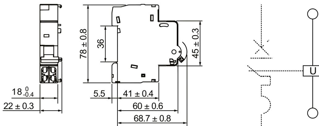
Аксессуары устанавливаются с левой стороны автоматического выключателя. Общая ширина установленных аксессуаров не должна превышать 54 mm. Максимальное количество устанавливаемых аксессуаров MX, MN, MV, MNS, MV+MN, MX+OF: не более двух одновременно.
