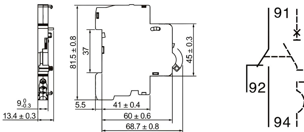
Аксессуары устанавливаются с левой стороны автоматического выключателя. Общая ширина установленных аксессуаров не должна превышать 54 mm. Максимальное количество устанавливаемых аксессуаров MX, MN, MV, MNS, MV+MN, MX+OF: не более двух одновременно.
